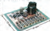
研究室で開発した蓄電池用 パワーエレクトロニクス回路
