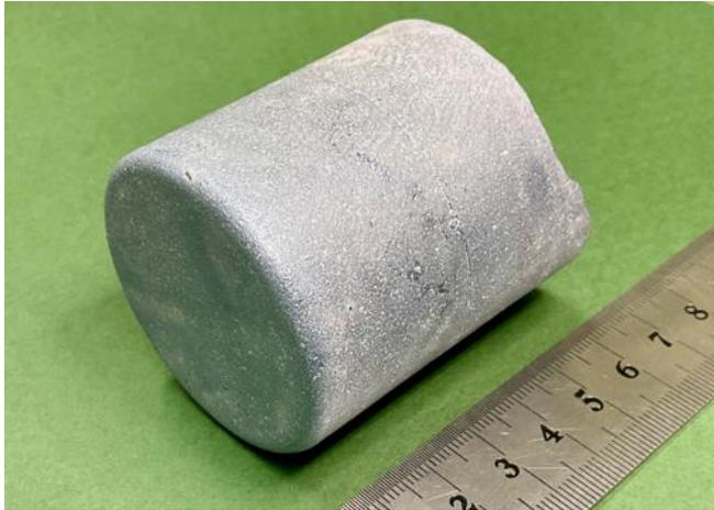
図1 φ50mm Mg<sub>2</sub>Si バルク結晶体
