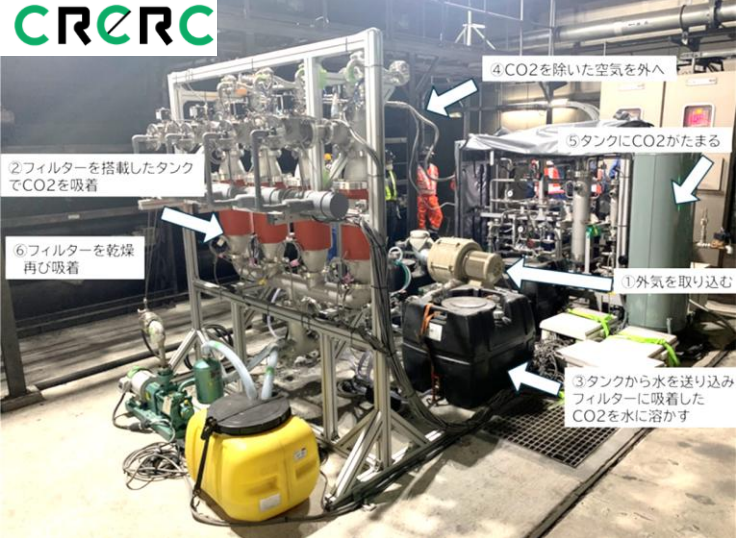
▲湿度スイング式DACの実証実験設備
