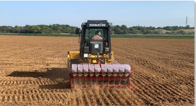
▲農業用アタッチメント(V溝播種機)を装着したコマツの農業用ブルドーザー
