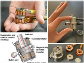
▲磁気浮上型人工心臓のポンプ
