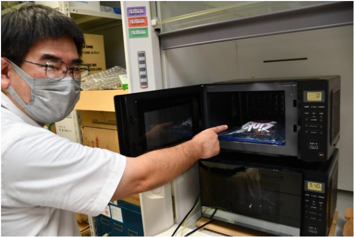
鳥養教授 試行錯誤により測定には電子レンジで100W・15分加熱が最適であることにたどり着きました
